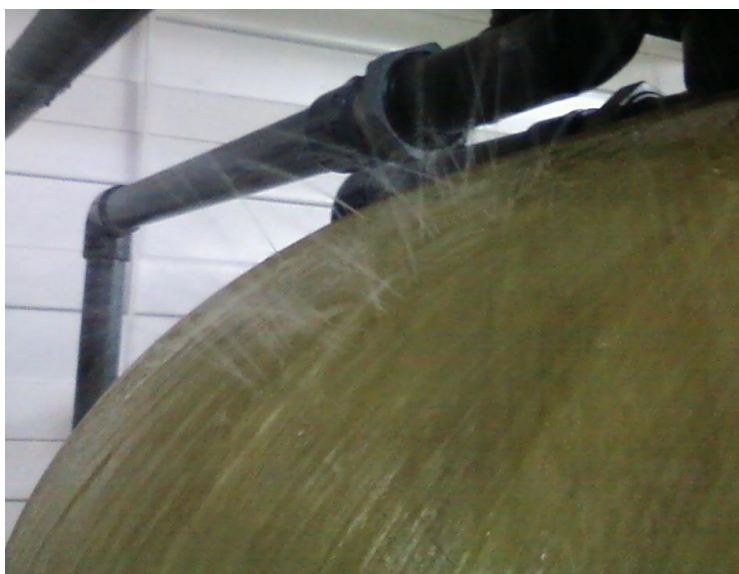
Рис. 1,2 Трещина внутренней колбы в результате транспортировки в условиях низкой температуры (менее: – 15 °С).
