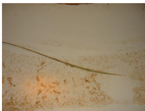
Рис. 1,2 Трещина внутренней колбы в результате транспортировки в условиях низкой температуры (менее: – 15 °С).
