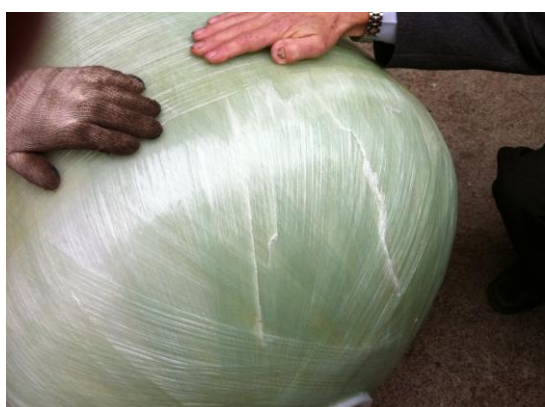
Рис. 7 Механическое повреждение при проведении такелажных работ или транспортировке.
