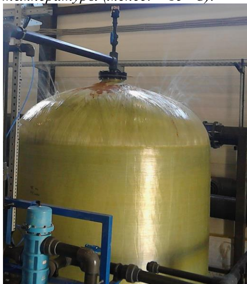
Рис. 1,2 Трещина внутренней колбы в результате транспортировки в условиях низкой температуры (менее: – 15 °С).
