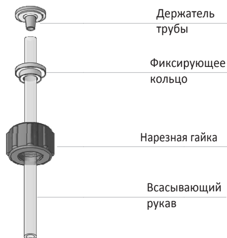
Рис. 6 Монтаж всасывающего рукава
